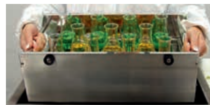
Вынимаемый подвижный короб: прямой контакт с теплоносителем исключен. Комплектацию платформ возможно производить отдельно от бани.
