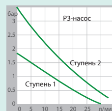
Мощность насоса P3 Теплоноситель: вода
